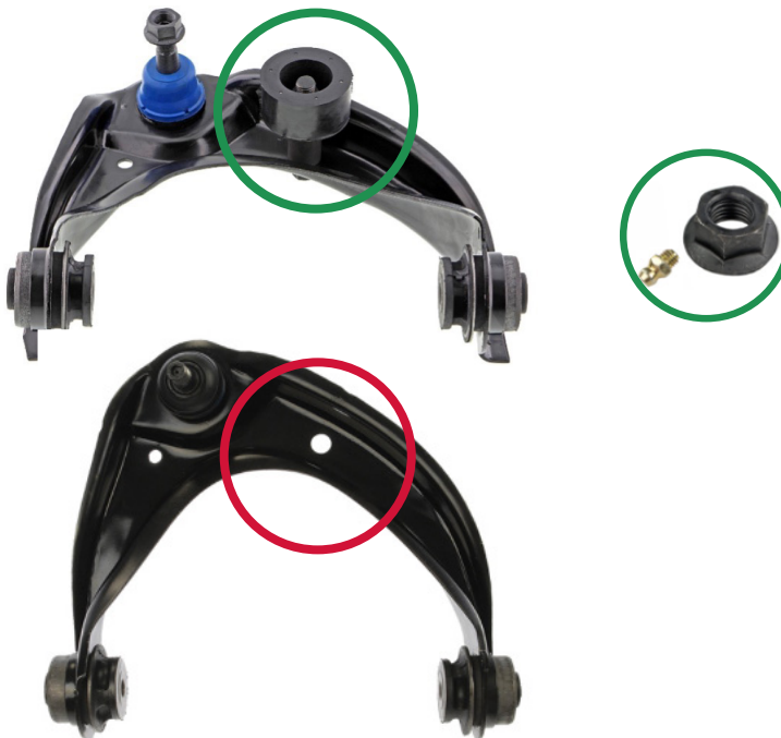
Figure 1. Bras de suspension Mevotech Supreme avec joint à rotule en métal fritté autolubrifiant et graissable, butée prémontée et matériel (en haut) comparativement au bras de suspension d'origine (en bas)
